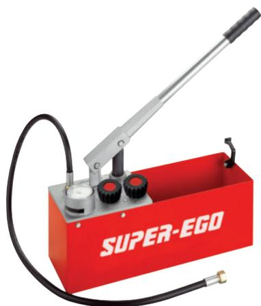
El sistema TWIN-VALVE y el vástago de la válvula con la cabeza esférica resistentes a la oxidación, aseguran una presión constante / Émbolo de poliamida sin distorsión, resistente al desgaste / Manómetro de fácil lectura y escala precisa / Depósito galvanizado y pintado resistente a la intemperie y bajas temperaturas / Cuerpo de válvula monoblock.
